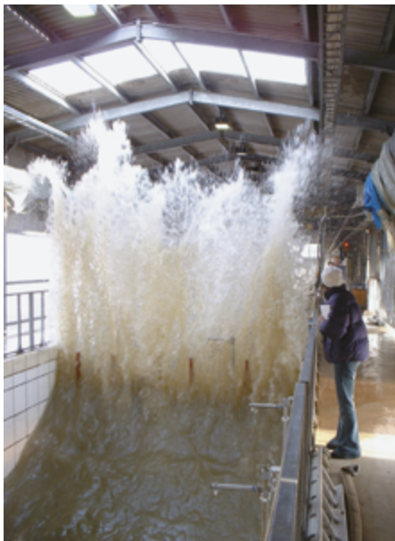
Eine brechende Welle an einem Caisson-Wellenbrecher • Foto: Forschungszentrum Küste
