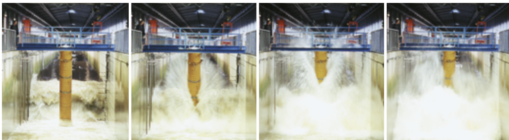
Zeitliche Abfolge einer brechenden Welle auf ein geneigtes Pfahlbauwerk in vier Schritten • Foto: Forschungszentrum Küste
