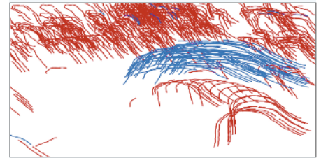
Aus der Videosequenz einer sich bewegenden Kamera (oben) macht die automatische Segmentierung (unten) die Autobewegung sichtbar: Die blauen Linien geben das Auto wieder, die roten Linien den Hintergrund.
