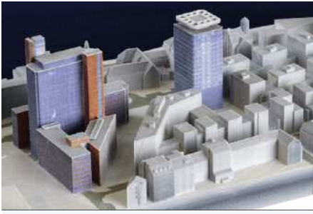
Städtemodelle aus dem 3D-Drucker, hier von Hamburg, sind wichtiger Bestandteil des Building Information Modeling. Datenbankbasierte Informationen und Modelle vereinfachen die Kommunikation zwischen allen Baubeteiligten.
