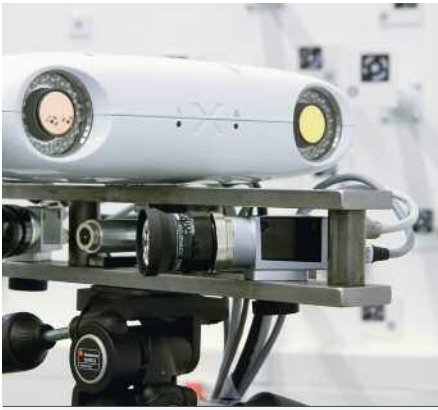
Kalibrierung eines Mehrkameranensystems (bestehend aus AXIOS CamBar B2, oben, und Basler ace, unten) an einem Testfeld (Hintergrund)
