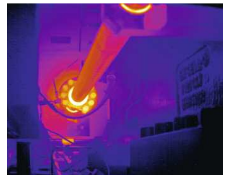
Temperaturmessung bewegter Komponenten am Beispiel eines Kugelgewindetriebs
