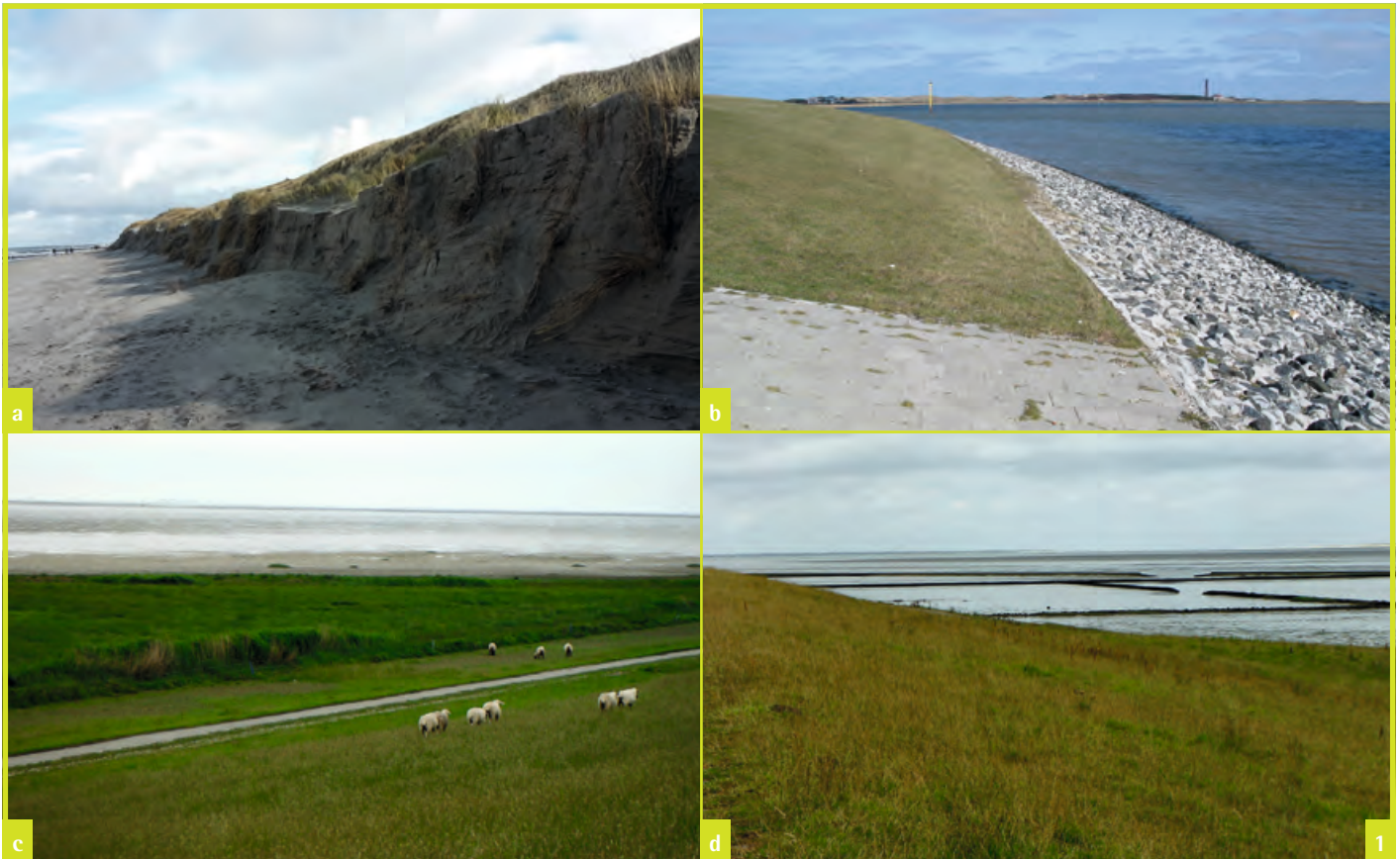
Abbildung 1 von oben links nach unten rechts: a) Dünenabbruch als Resultat von Orkan Sabine auf Norderney; b) Geschlossenes technisches Deckwerk als Deichfußsicherung auf der Wattseite von Norderney; c) Salzwiesen im Deichvorland, Leybucht; d) Lahmungen im Deichvorland zwischen Neu-harlingersiel und Bengersiel alle Fotos: Maïke Paul
