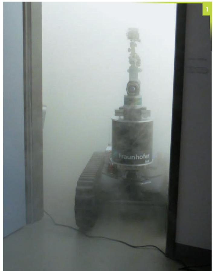
spielsweise Regen, Schnee, Nebel, Rauch oder Staub) kommen mobile Roboter mit traditionellen Sensoren (Kameras, Laserscanner, Tiefenkameras, etc.) hinsichtlich ihrer Zuverlässigkeit an ihre Grenzen. Aus diesem Grund werden im Projekt SmokeBot hard- und softwarebasierte Ansätze entwickelt, um die Umgebungswahrnehmung in Szenarien mit begrenzter Sichtbarkeit zu verbessern
