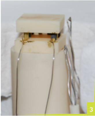
Abbildung 3 Oxidbasierter thermoelektrischer Generator vor dem Schamott einer Hochtemperaturanlage. Quelle: Institut für Physikalische Chemie und Elektrochemie; Foto: Benjamin Geppert
