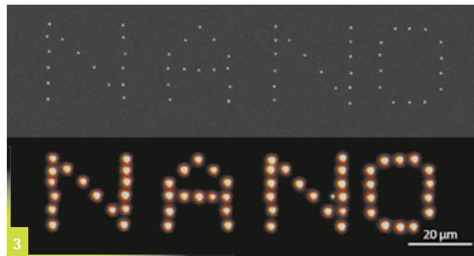
Abbildung 3 Oben: Gold-Nanopartikel bilden das Wort »Nano«. Jeder Buchstabe ist in etwa nur halb so groß wie der Durchmesser eines menschlichen Haares. Unten: Ein Dunkelfeldmikroskop bringt die Nanopartikel zum Strahlen.
