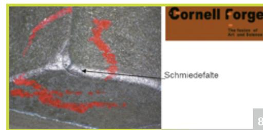
dung aufwändiger und zeitintensiver Vorserienversuche. Mit Hilfe der FE-Simulationen können die Schmiedeprozesse im Hinblick auf fehlerfreie Bauteile ausgelegt werden. Wesentliche Fehlerarten hierbei sind Schmiedefalten, Reißen sowie unzureichende Maßhaltigkeit aufgrund des Verzug bei der Abkühlung. In
