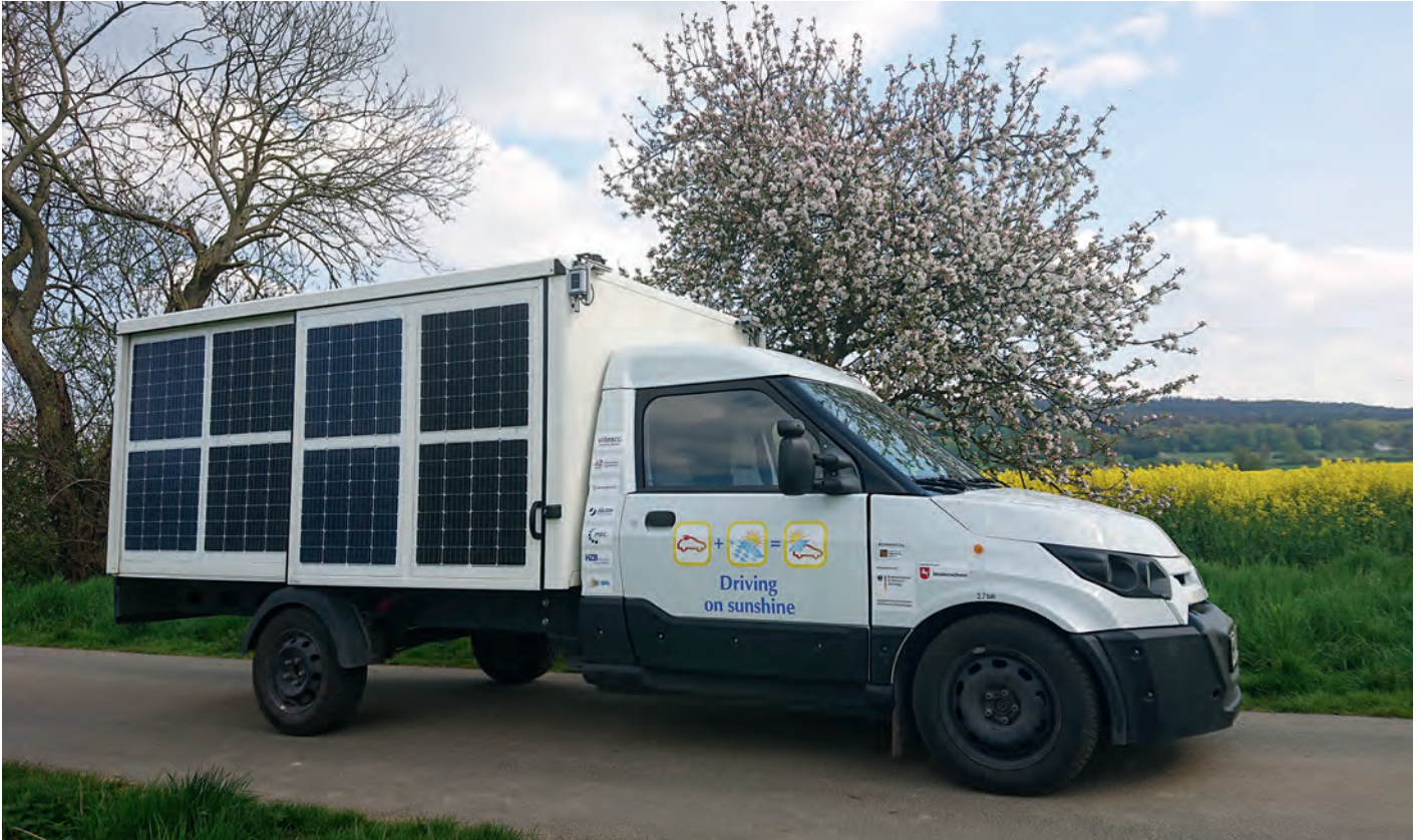
Driving on sunshine: Das Projekt zur fahrzeugintegrierte Photovoltaik ist eine Kooperation vom ISFH mit dem Institut für Bauelemente der Elektrotechnik und Partnern aus Industrie. Foto: ISFH
