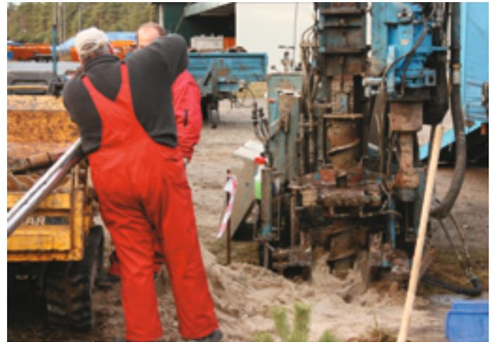
Bodenprobenentnahme im Hohlbohrschneckenverfahren
