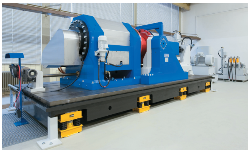
Abbildung 5 Großwälzlagerprüfstand Quelle: Eilhauer Maschinenbau GmbH
