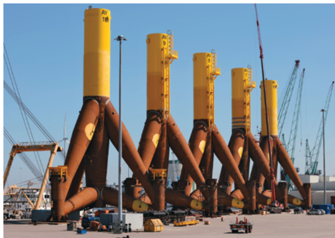
Abbildung 3 Tripods als Unterstruktur für Alpha Ventus Quelle: Offshore-Stiftung/Multibrid/Jan Oelker, 2009 aus [AV]
