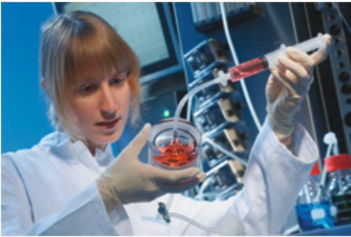
Abbildung 3 Perfusions-Bioreaktor Foto: Franke, TCI
