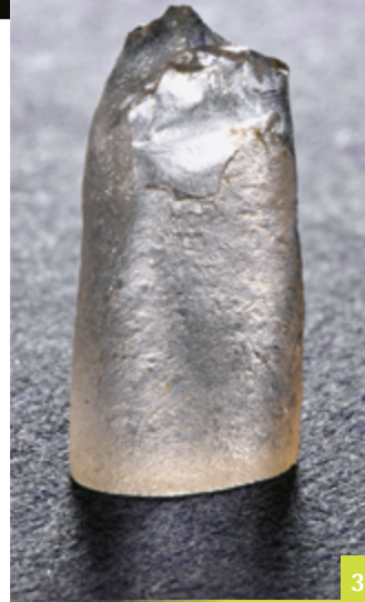
Abbildung 3 Synthetisches Glas mit 10 Gewichtsprozent gelöstem Wasser. Das Glasstück ist 10 mm hoch. Foto: Dawid Murawski, Institut für Mineralogie
